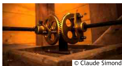
Pignons et tubes transmettent le mouvement.
